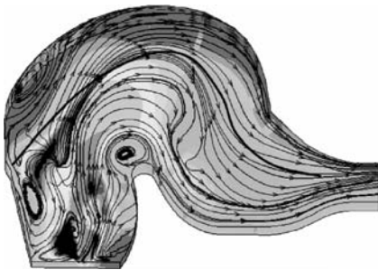
图 2 折流燃烧室内部典型流动结构示意图 Fig. 2 Schematic of typical flow pattern in annular slinger combustor
